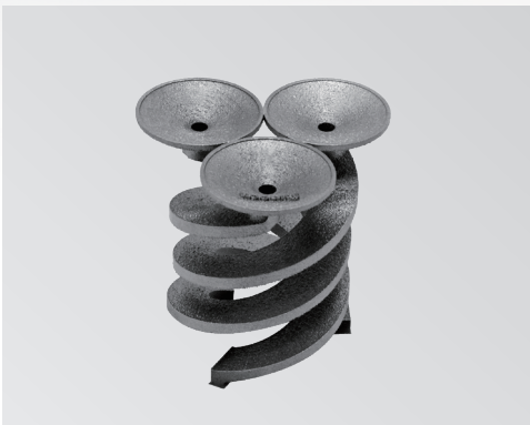
样品名称：少支撑技术螺旋锥台 打印设备：FS191M 打印材料：钛合金
