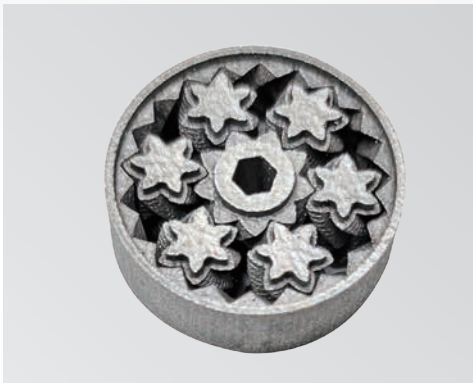
样品名称：轴承活动件 打印设备：FS121M 打印材料：FS 316L
