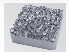
样品名称:义齿基板 打印设备:FS121M-E 打印材料:FS CoCrMoW
